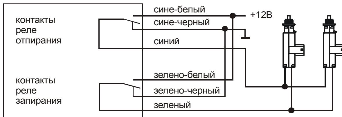
**Схема подключения к пневматической системе запирания**
