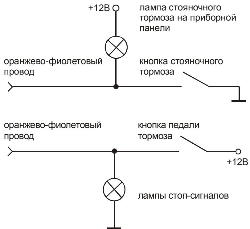
На автомобилях с автоматической КПП подключите этот провод к кнопке педали тормоза, замыкающейся на +12В при нажатии педали тормоза.
