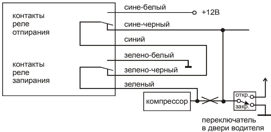
**Схема подключения активатора двери водителя
