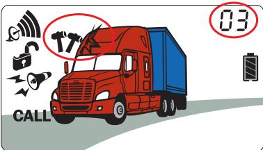
Если в режиме охраны система срабатывала только от датчика вызова владельца, то при снятии с охраны система сообщает об этом миганием символа **CALL** на дисплее брелока, надписью «**CALL**» и указанием числа срабатываний:
