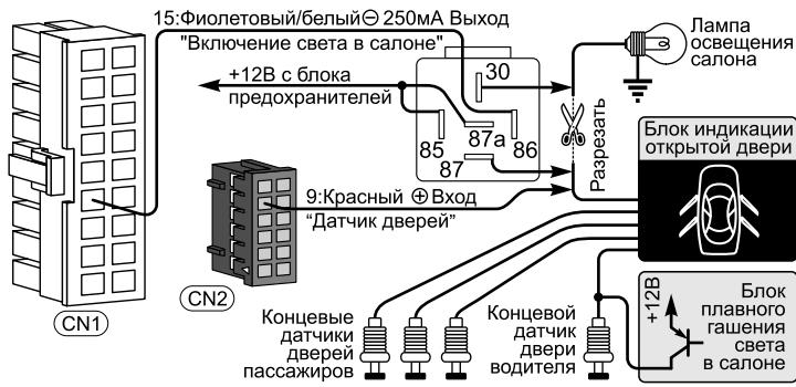
Для использования данной схемы необходимо установить значение 1 ( заводское значение ) программируемой функции 23. В этом случае для блокировки зажигания или стартера может быть использовано встроенное прогр. реле ( см. схему 1 ).
