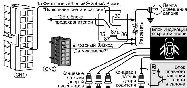
Для использования данной схемы необходимо установить значение 1 ( заводское значение ) программируемой функции 23. В этом случае для блокировки зажигания или стартера может быть использовано встроенное прогр. реле ( см. схему 1 ).
