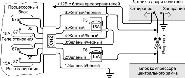
**6. Жёлтый/чёрный провод: нормально замкнутый (НЗ) контакт №87а внутреннего реле отпирания центрального замка автомобиля (15A).**
