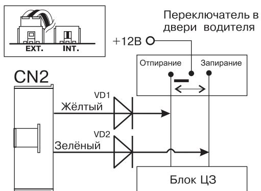
**Подключение к блоку ЦЗ, для управления которым требуются импульсы положительной полярности, и в схеме есть переключатель ручного управления ЦЗ:**
