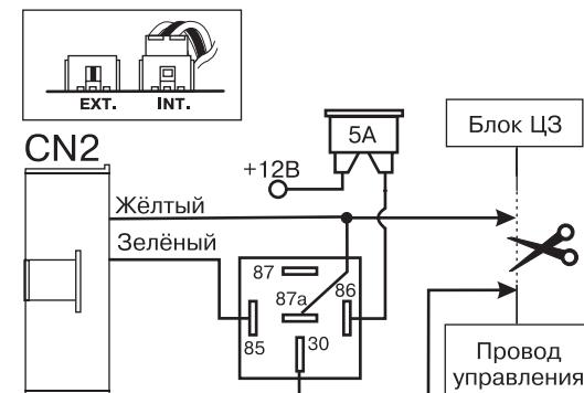
Схема управления замком багажника
