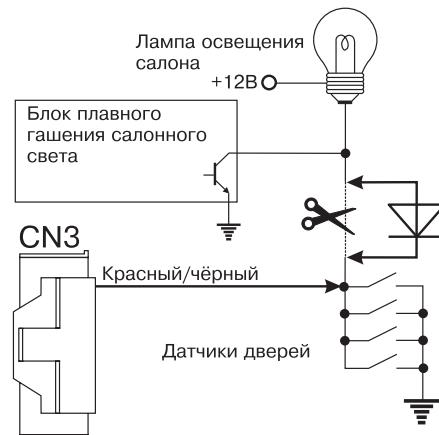
Подключение датчиков дверей для автомобилей, имеющих блок диагностики открытой двери (на приборной панели имеется индикатор открытой двери, указывающий на конкретную дверь)
