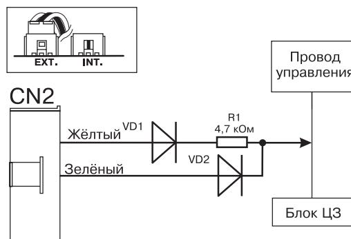
Схема отрицательного однопроводного управления MAZDA:
