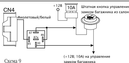
Если в автомобиле штатно установлена кнопка управления замком багажника, то используйте схему 9.
