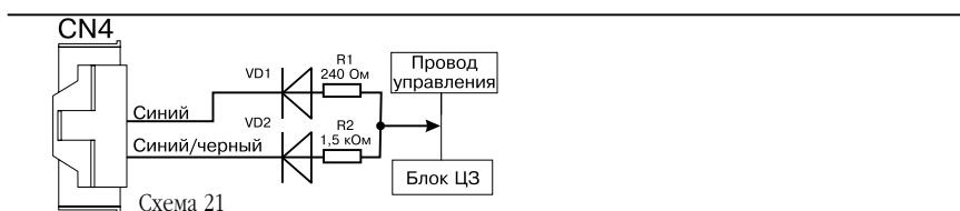
**Схема отрицательного однопроводного управления Mazda**
