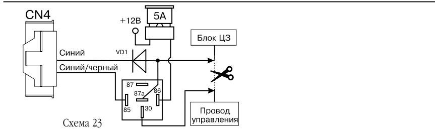
**Схема отрицательного однопроводного управления Mercedes ML**
