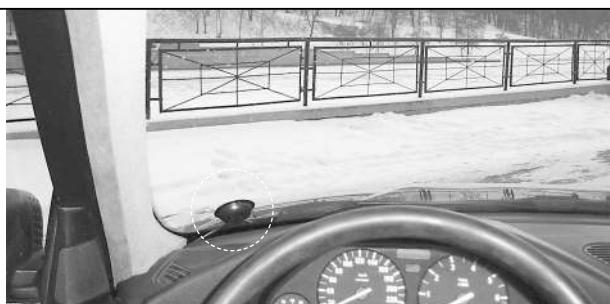
Датчик вызова из автомобиля может быть установлен в нижнем левом или правом углу лобового стекла автомобиля. Перед установкой датчика следует обезжирить поверхность стекла в месте монтажа спиртовой салфеткой. Температура стекла при монтаже должна быть не менее +10 °C.
