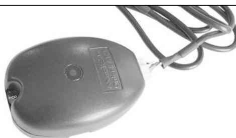
Выберите место на прочной поверхности в салоне и установите датчик удара при помощи двух винтов (пластиковых стяжек или двухсторонней липкой основы). Убедитесь в наличии свободного доступа к датчику для его регулировки. Увеличение чувствительности датчика происходит поворотом регулятора по часовой стрелке, уменьшение чувствительности производится поворотом регулятора против часовой стрелки.
