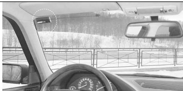
Антенный блок может быть установлен в верхнем углу лобового стекла. Расстояние от антенны до ближайшей металлической поверхности должно быть не менее 50 мм. Перед установкой антенного блока следует обезжирить поверхность стекла в месте монтажа спиртовой салфеткой. Температура стекла при монтаже должна быть не менее +10 °C.
