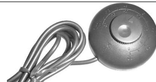
Выберите место в салоне автомобиля и установите датчик температуры со стороны салона при помощи двух винтов (пластиковых стяжек или двухсторонней липкой основы). Перед установкой датчика следует обезжирить поверхность в месте монтажа спиртовой салфеткой. Температура поверхности при монтаже должна быть не менее +10 °C.
