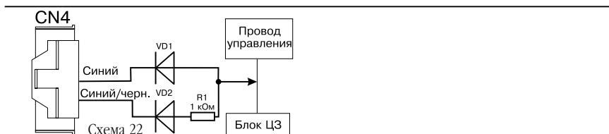
**Схема отрицательного однопроводного управления Nissan, Mazda (для запирания требуется разомкнутое состояние провода управления)**
