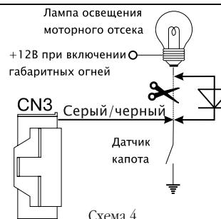
провод. Возможно подключение серого/черного провода к штатному датчику открытия капота (если он установлен). Если датчик управляет включением освещения моторного отсека, то необходимо применить диодную развязку для его подключения (см. схему 4). Диод может быть с максимальным прямым током 1А. В схеме можно применить диод зарубежного производства типа 1N4000-1N4007 или Российский аналог КД243 (А-Ж).
