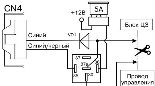
**СХЕМА ОТРИЦАТЕЛЬНОГО ОДНОПРОВОДНОГО УПРАВЛЕНИЯ MERCEDES ML**
