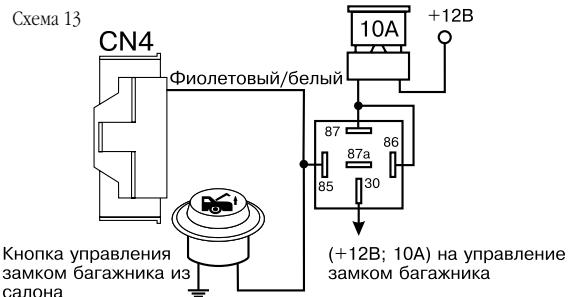
Если в автомобиле уже установлена кнопка управления замком багажника из салона
