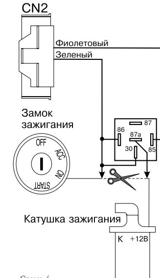
**Схема блокировки стартера:**
