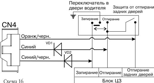
Схема включения датчиков дверей для автомобилей ВАЗ 211xx, и автомобилей иностранного производства, имеющих блок диагностики открытой двери (на приборной панели имеется индикатор незакрытой двери с указанием на конкретную дверь). Задержка выключения салонного света происходит только после закрытия водительской двери. После закрытия любой из пассажирских дверей свет в салоне гаснет сразу.
