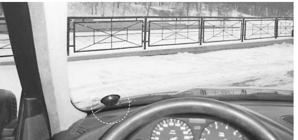
Датчик вызова из автомобиля может быть установлен в нижнем левом или правом углу лобового стекла автомобиля. Перед установкой датчика следует обезжирить поверхность стекла в месте монтажа спиртовой салфеткой. Температура стекла при монтаже должна быть не менее +10°C.
