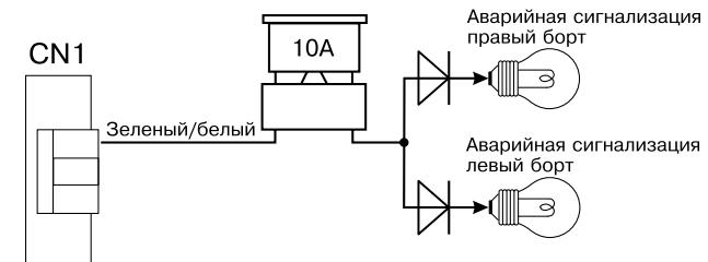
Этот провод обеспечивает мигание аварийной сигнализации при постановке (и снятии) СТСС с охраны, срабатывании СТСС и при включении режима Паника. В том случае, если в автомобиле необходимо разделить правую и левую цепи аварийной сигнализации, необходимо применить диодную развязку. Для диодной развязки используйте диоды с прямым током не менее 5А и обратным напряжением не менее 40В.
