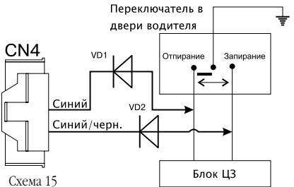
**ВАРИАНТЫ ПОДКЛЮЧЕНИЯ К БЛОКУ ЦЗ, ДЛЯ УПРАВЛЕНИЯ КОТОРЫМ ТРЕБУЮТСЯ ИМПУЛЬСЫ ОТРИЦАТЕЛЬНОЙ ПОЛЯРНОСТИ И ЕСТЬ КНОПКА ЗАПРЕТА ОТПИРАНИЯ ЗАДНИХ ДВЕРЕЙ (применяется на автомобилях TOYOTA)**
