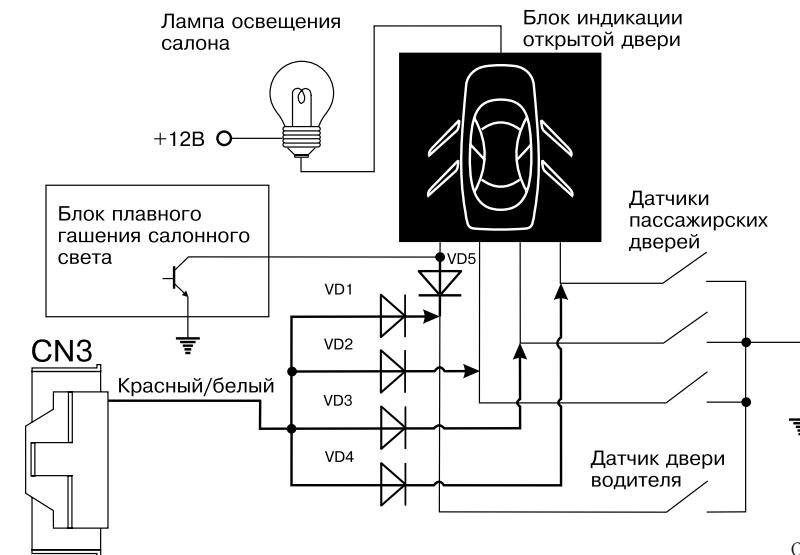
Схема включения датчиков дверей для автомобилей иностранного производства, имеющих блок диагностики открытой двери (на приборной панели имеется индикатор незакрытой двери с указанием на конкретную дверь). Задержка выключения салонного света происходит после закрытия любой из дверей.
