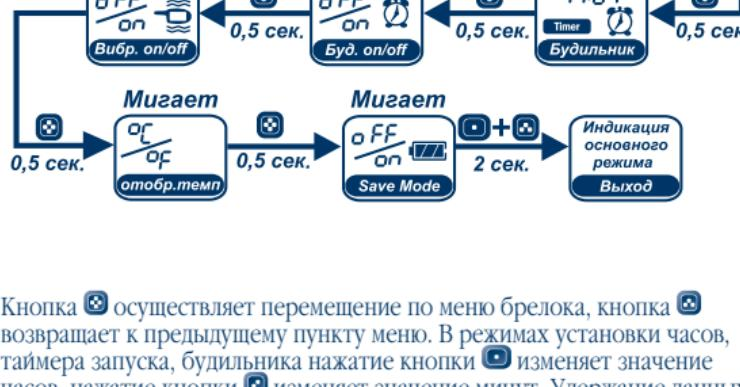
Кнопка осуществляет перемещение по меню брелока, кнопка возвращает к предыдущему пункту меню. В режимах установки часов, таймера запуска, будильника нажатие кнопки изменяет значение часов, нажатие кнопки изменяет значение минут. Удержание данных кнопок приводит к быстрой перемотке значений. Нажатием кнопки последовательно изменяется текущее состояние функций on - off - on (вкл. - выкл. - вкл.).
