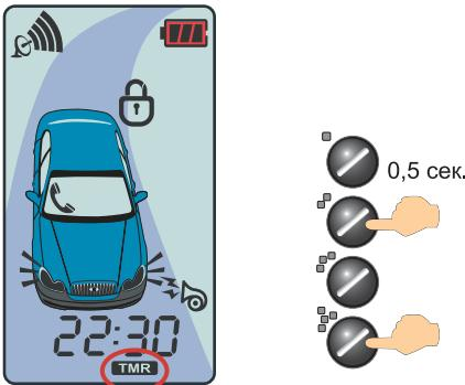
**При включении функции активации дополнительного канала по таймеру:**
