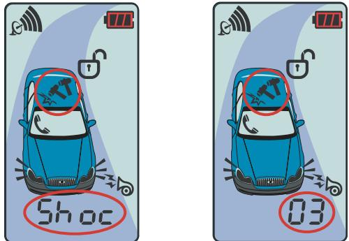
Если в режиме охраны система срабатывала только от датчика вызова владельца, то при снятии с охраны система сообщит об этом миганием символа
