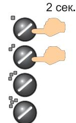
Для возврата в режим управления первым автомобилем нажмите кнопки (I+II) брелока на 2 сек. Вы услышите два коротких сигнала брелока, символ исчезнет с дисплея, брелок перейдет в режим управления первым автомобилем.
