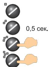
Для выключения блокировки клавиатуры коротко нажмите кнопки (III+IV) брелока. Вы услышите два коротких сигнала и клавиатура разблокируется. В режиме «Тревога» данная функция автоматически отключается.
