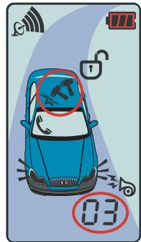
Если в режиме охраны система срабатывала только от датчика вызова владельца, то при снятии с охраны система сообщит об этом миганием символа на дисплее брелока, надписью «CALL» и указанием числа срабатываний.
