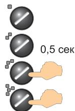
Для выключения блокировки клавиатуры кратковременно нажмите кнопки (III+IV) брелока. Вы услышите два коротких сигнала брелока, клавиатура брелока разблокируется. При получении брелоком сигнала тревоги блокировка клавиатуры отключается автоматически.
