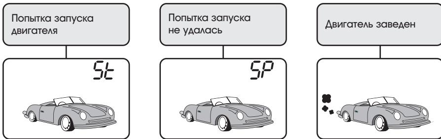
Двигатель будет работать в течение предварительно запрограммированного времени (см. таблицу программируемых функций), после чего автоматически заглушится. Время прогрева двигателя индицируется на дисплее.
