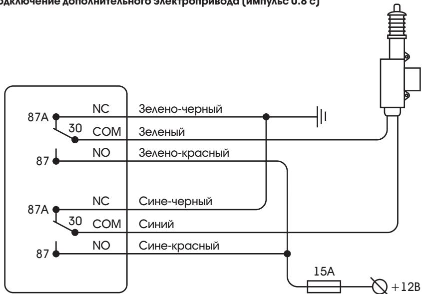
Подключение к штатному блоку с позитивным управлением (импульс 0.8 с)
