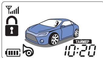
В системе предусмотрено четыре режима запуска двигателя по таймеру. Первый режим позволяет запускать двигатель каждые сутки в заранее установленное время, второй режим позволяет запускать двигатель периодически каждые 8 часов, третий – каждые 4 часа, четвертый – каждые 2 часа для прогрева (или охлаждения салона в регионах с жарким климатом). Два режима не могут быть использованы одновременно.
