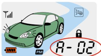
Для выключения сигнала на выходе дополнительного канала 2 нажмите кнопки (II+III) брелока на 0,5 сек.
