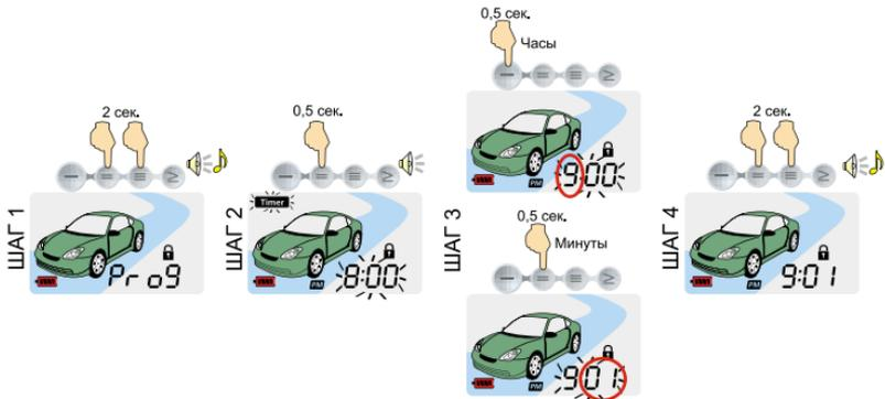
Для того, чтобы включить или выключить запуск двигателя по таймеру каждые 8, 4 или 2 часа, воспользуйтесь коротким нажатием кнопок (II+IV) брелока.
