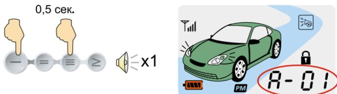
Для выключения сигнала на выходе дополнительного канала 1 нажмите кнопки (I+III) брелока на 0,5 сек.
