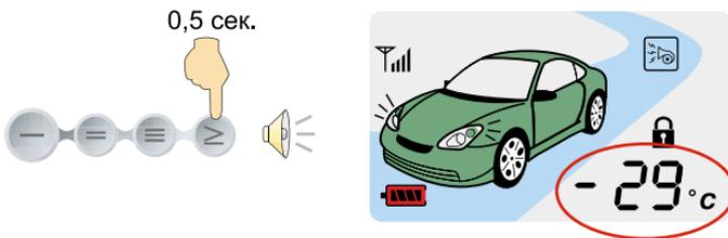
При проверке состояния системы индикатор текущего времени показывает значение температуры в салоне автомобиля. Температура может отображаться или в  $^{\circ}\text{F}$ , или  $^{\circ}\text{C}$  (см. стр. 15).
