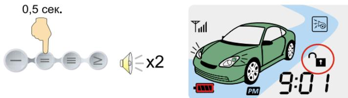
Если при снятии с охраны Вы услышали 6 коротких сигналов сирены\*, а аварийная сигнализация вспыхнула 6 раз, то это значит, что за время охраны система входила в режим тревоги от датчиков дверей, капота/багажника или зажигания.
