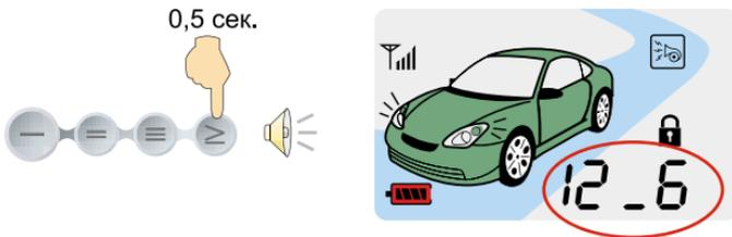
Повторное короткое нажатие кнопки IV брелока-коммуникатора в течение 6 секунд после первого, позволяет посмотреть информацию о напряжении аккумулятора автомобиля в вольтах.
