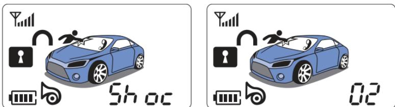
Если в режиме охраны система срабатывала от датчика вызова владельца, то при снятии с охраны система сообщит об этом миганием символа
