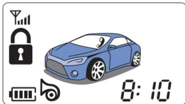
Показания индикатора изменяются только при получении сигнала обратной связи. Проверить качество обратной связи между процессорным блоком и брелоком можно коротким нажатием кнопки IV брелока-коммуникатора.
