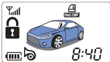
Если выбрано значение 4 программируемой функции 1-4 (см. стр. 78), то система в режим охраны не встает, а только включает блокировку стартера (зажигания) по истечении 30 сек. после выключения зажигания или по завершении режимов резервирования запуска, Pit-Stop и «Турбо».
