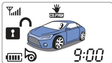
Смена режимов работы происходит длительным 2 сек. нажатием кнопок II+III брелока-коммуникатора в следующем порядке: (Функция выключена) > (Функция включена, режим 1) > (Функция включена, режим 2) > (Функция выключена) и т.д.
