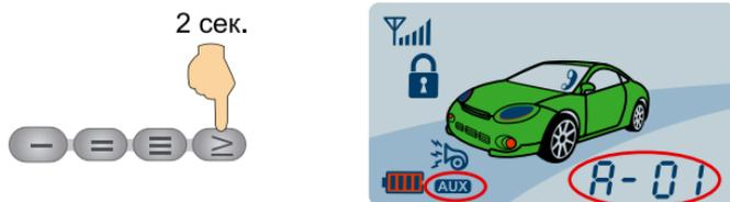
**Включение дополнительного канала:**
