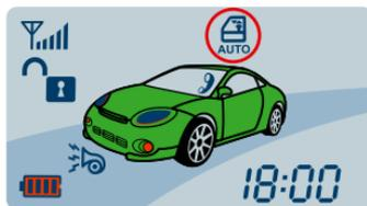
Смена режимов работы происходит длительным двухсекундным нажатием кнопок II+III брелока-коммуникатора в следующем порядке: (функция включена, режим 1) > (функция включена режим 2) > (функция выключена) > (функция включена, режим 1) и т. д.
