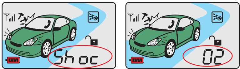
\* Наличие сигналов сирены определяется значением программируемой функции 1-3 (см. стр. 62) и комбинацией кнопок I+II (см. «Отключение сигналов сирены» на стр. 31).
