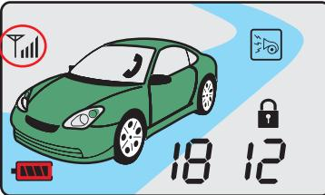
Показания индикатора изменяются только при получении сигнала обратной связи. Проверить наличие связи между процессорным блоком и брелоком можно нажатием кнопки IV брелока-коммуникатора.
