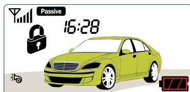
Если выбрано значение 4 программируемой функции 1-4, (см. стр. 62), то система в режим охраны не встает, а только включает блокировку стартера (зажигания) по истечении 30 сек. после выключения зажигания или по завершении режимов резервирования запуска, Pit-Stop и «Турбо».
