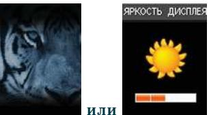
Выбор фонового изображения и регулировка яркости дисплея брелока производится коротким нажатием кнопок **I** или **III**, применение выбранных параметров – коротким нажатием кнопки **II** или удержанием кнопки **I** на 2 сек., возврат в предыдущее меню без сохранения настроек – коротким нажатием кнопки **IV**.
