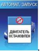
затем брелок на 8 сек. перейдет в режим отображения состояния системы. Система останется в режиме охраны и через 30 сек. после остановки двигателя начнет контролировать датчик удара.
