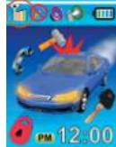
Показания индикатора обратной связи изменяются только при получении сигнала обратной связи. Проверить наличие и качество связи между процессорным блоком и брелоком можно кратковременным нажатием кнопки **IV** брелока-коммуникатора.
