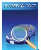
затем брелок на 8 сек. перейдет в режим отображения состояния системы. Информация о состоянии системы будет показана на дисплее брелока-коммуникатора и подтверждена сигналами сирены и аварийной сигнализации. Если ни один из входов системы не активирован, в режиме отображения состояния первые 4 сек. на дисплее брелока-коммуникатора будет отображаться заставка.
