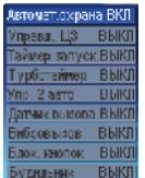
Если выбрано значение 4 программируемой функции 1-5, (см. стр. 83), то система в режим охраны не встает, а только включает блокировку стартера (зажигания) по истечении 30 сек. после выключения зажигания или по завершении режимов резервирования запуска, Pit-Stop и «Турбо».
