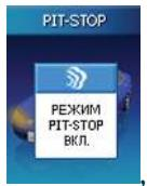
затем брелок на 8 сек. перейдет в режим отображения состояния системы, при этом, показания текущего времени сменятся оставшимся временем работы в режиме Pit-Stop.
