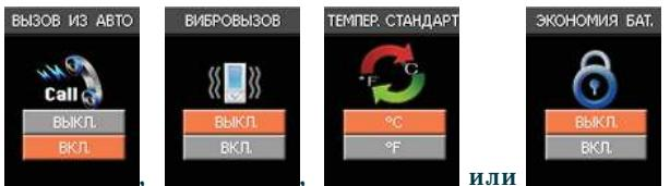
Включение, выключение функций и выбор формата отображения температуры производится коротким нажатием кнопок **I** или **III**, применение выбранных параметров – коротким нажатием кнопки **II** или удержанием кнопки **I** на 2 сек., возврат в предыдущее меню без сохранения настроек – коротким нажатием кнопки **IV**.
