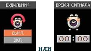
Включение, выключение будильника и установка времени производится коротким нажатием кнопок **I** или **III**, переход от часов к минутам – коротким нажатием кнопки **II** или удержанием кнопки **I** на 2 сек., применение выбранных параметров – коротким нажатием кнопки **II** или удержанием кнопки **I** на 2 сек. после того, как включен будильник или установлено значение минут. Возврат в предыдущее меню без сохранения настроек – коротким нажатием кнопки **IV** брелока.
