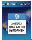
затем брелок на 8 сек. перейдет в режим отображения состояния системы, при этом, показания текущего времени сменятся оставшимся временем работы двигателя в автоматическом режиме:
