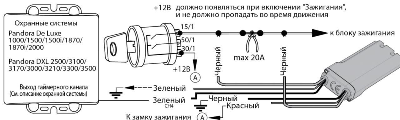
В режиме программирования "Зеленый" провод соединить с "Массой" таймерного канала, после успешного программирования "Зеленый" провод отсоединить и заизолировать
