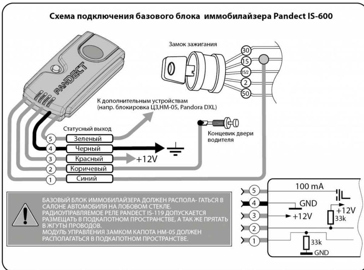
**Провод «4» (Черный) («Масса»)** базового блока должен быть присоединен к кузову автомобиля или надежному проводнику, соединяющему кузов и какой-либо штатный потребитель. Данный провод подсоединяется при монтаже в первую очередь.
