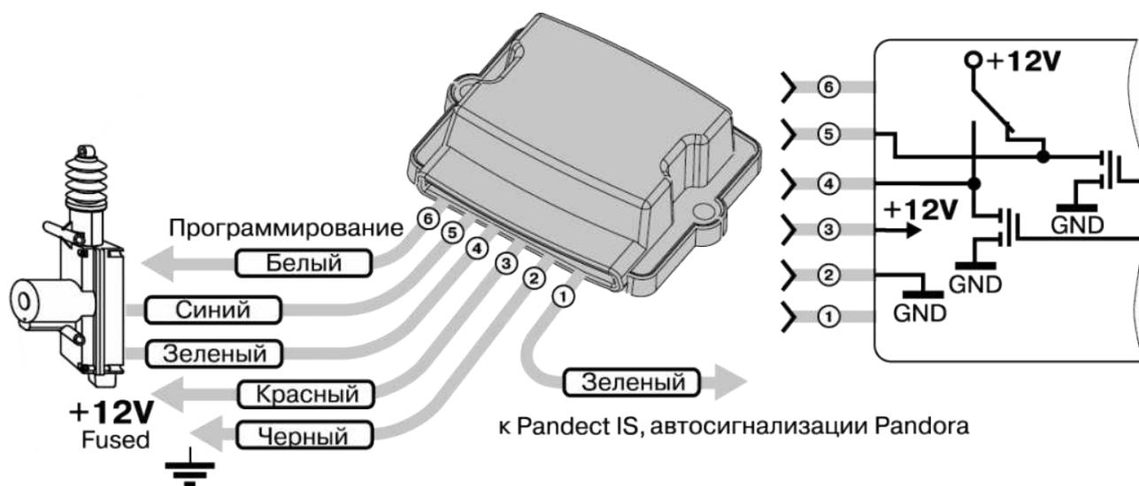
**Провод «1» (зеленый)** модуля управления должен быть присоединен к управляющему проводу (зеленый) (СН4) базового блока автосигнализации **Pandora**.
