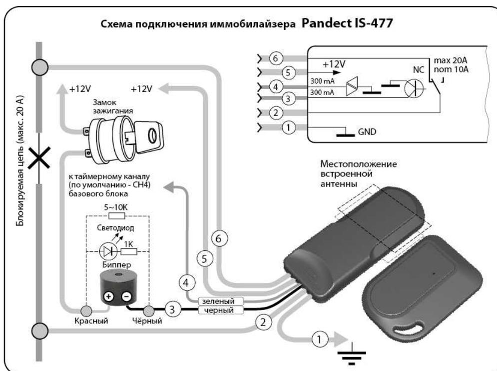
1. Зачистить концы проводов, выходящие из модуля. Подключить модуль в соответствии со схемой:
