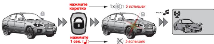
Для того чтобы облегчить поиск своего автомобиля на крупной автостоянке, коротко нажмите на кнопку во время, когда автомобиль находится под охраной, система выдаст 5-кратный звуковой сигнал сирены и пять вспышек указателей поворота.
