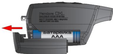
При использовании качественных элементов питания брелок охрально-сервисной системы может функционировать без замены элемента питания до 6 месяцев.
