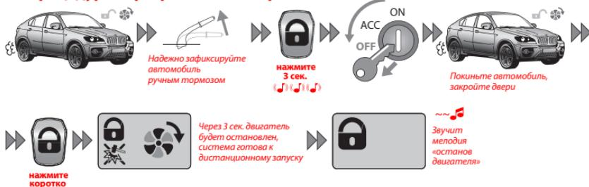
В случае если предполагается использовать дистанционный или автоматический запуск двигателя на автомобиле с МКПП, то перед постановкой автомобиля на охрану необходимо выполнить следующую последовательность действий:
