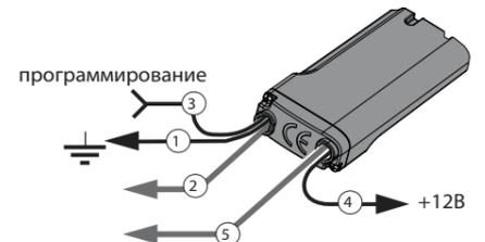
**Провод «1»** (Черный) реле блокировки должен быть присоединен к кузову автомобиля или надежному проводнику, соединяющему кузов и какой-либо штатный потребитель. Данный провод подсоединяется при монтаже в первую очередь.
