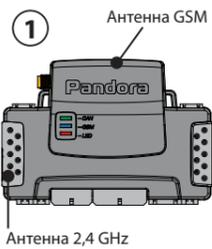
Рекомендуется располагать базовый блок системы под «торпедой» или в районе приборной панели разъемами вниз. При этом обеспечьте жесткое крепление к кузову автомобиля или деталям непосредственно связанным с кузовом. Встроенная GSM и 2,4 GHz-антенны не должны экранироваться металлическими элементами конструкции автомобиля. В случае если место установки не обеспечивает устойчивого приема сигнала сотовой сети, необходимо использовать внешнюю GSM-антенну.
