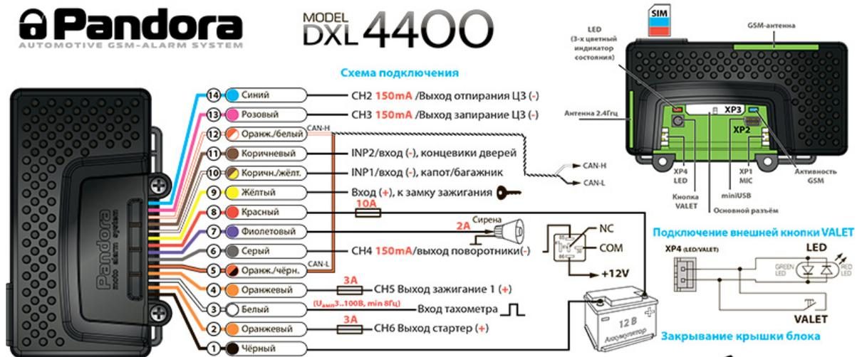
**Распиновка разъёма XP4 на базовом блоке**
