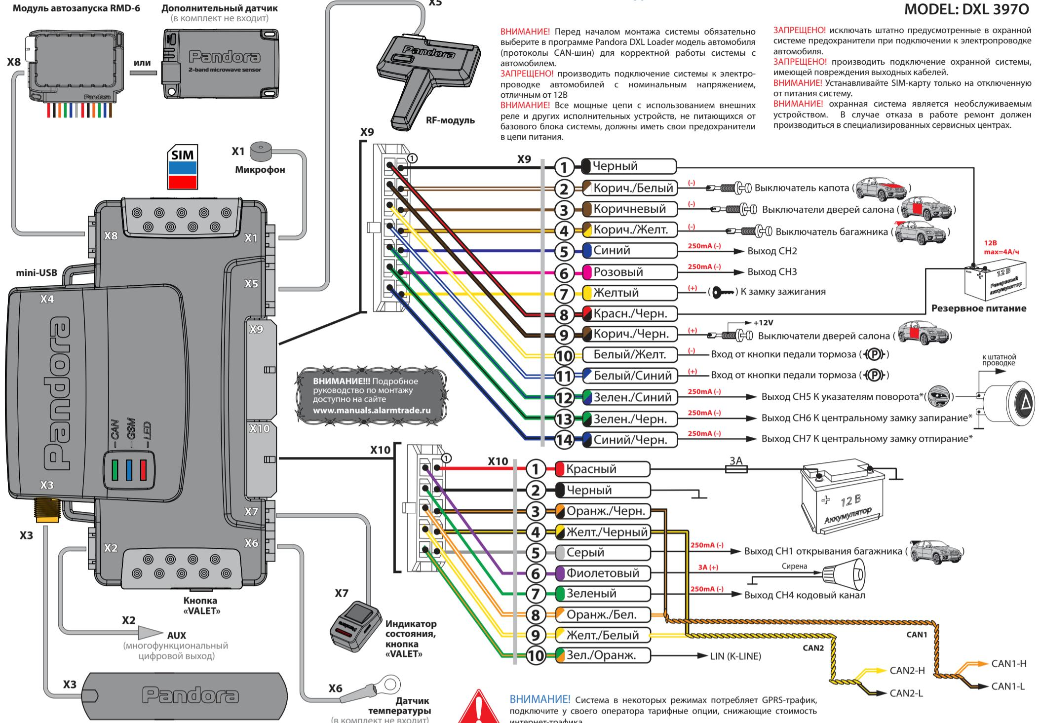
**ЗАПРЕЩЕНО!** исключать штатно предусмотренные в охранной системе предохранители при подключении к электропроводке автомобиля.
