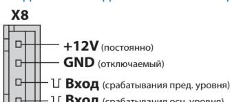
Входы отрабатывают импульсы отрицательной полярности длительностью не менее 0,3 сек.
