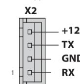
Данный разъем предназначен для цифрового управления дополнительными устройствами, например бесключевыми обходчиками штатных иммобилайзеров.
