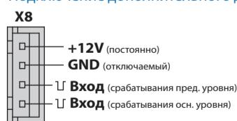
Входы отрабатывают импульсы отрицательной полярности длительностью не менее 0,3 сек.
