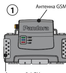
Рекомендуется располагать базовый блок системы под «торпедо» или в районе приборной панели разъемами вниз. При этом обеспечьте жесткое крепление к кузову автомобиля или деталям непосредственно связанным с кузовом. Встроенная GSM и 2,4 GHz-антенны не должны экранироваться металлическими элементами конструкции автомобиля. В случае если место установки не обеспечивает устойчивого приема сигнала сотовой сети, необходимо использовать внешнюю GSM-антенну.
