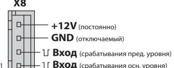
Входы отрабатывают импульсы отрицательной полярности длительностью не менее 0,3 сек.
