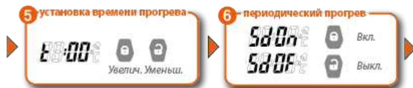
Ограничение времени прогрева двигателя устанавливается в меню «START» брелока в пределах 0 – 60 минут. Надо иметь в виду, что если также активировано условие останова двигателя по достижении заданной температуры, то останов двигателя произойдет при наступлении более раннего события. Максимальное время прогрева может быть ограничено (Настраивается в [меню программирования системы](#). Заводская установка 30 минут).
