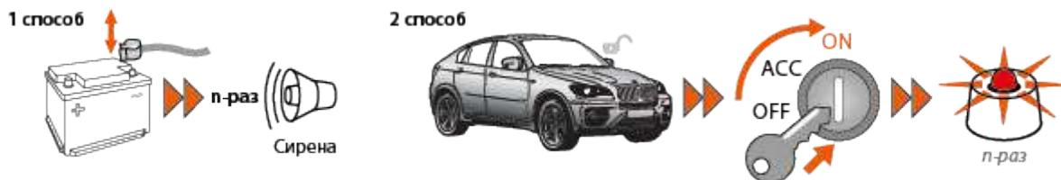
Проверить количество прописанных брелоков в систему можно, сняв и одев обратно клемму аккумулятора, при этом система количеством звуков сирены известит, сколько прописано брелоков. Также проверить количество брелоков можно по количеству оранжевых вспышек индикатора состояния при каждом включении зажигания при выключенном охране.
