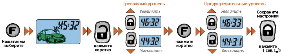
**Настройка чувствительности датчика движения** Данная функция предназначена для настройки чувствительности встроенного трехкоординатного датчика движения. Для входа в режим настройки последовательными нажатиями кнопки **F** выберите пиктограмму ,
