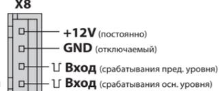
Входы обрабатывают импульсы отрицательной полярности длительностью не менее 0,3 сек.
