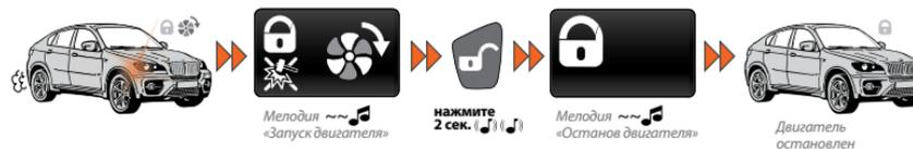
За одну минуту до штатной остановки двигателя на брелок придет оповещение, замигает пиктограмма и каждые 10 сек. будет звучать мелодия «ОСТАНОВ ДВИГАТЕЛЯ ЧЕРЕЗ 1 МИН.»
