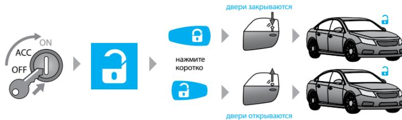
Предусмотрены режимы автоматического запирания дверей при начале движения или при включении зажигания. Отпирание дверей происходит при выключении зажигания сразу. В настройках предусмотрена возможность запрета отпирания дверей при выключении зажигания.
