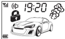
Успешная попытка запуска (когда система обнаруживает обороты холостого хода) сопровождается сменой индикации – отобразится анимированное изображение дыма и начнется обратный отсчет времени работы двигателя.
