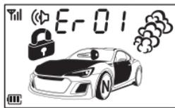
Если не закрыты двери, капот, багажник, включено зажигание, не включен стояночный тормоз, нажата педаль тормоза, селектор передач не в положении **P** (Parking), на брелок придет сообщение с номером ошибки, вызвавшей отказ (стр. 63).
