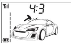
Вы находитесь в 7 пункте меню № 1 «Регулировка чувствительности двухзонного датчика удара». Первая цифра показывает текущий уровень чувствительности зоны предупреждения датчика удара. Вторая – уровень зоны тревоги. Цифра, соответствующая настраиваемой зоне, мигает. Коротким
