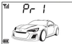
Для входа в меню № 1 при выключенной охране или в режиме «Автосервис» нажмите и удерживайте **I** + **IV** (до звукового сигнала брелока).
