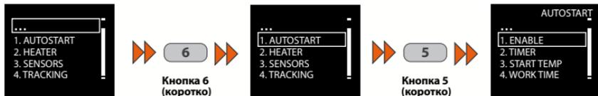
1. **ENABLE** - включение/выключение автоматического запуска
