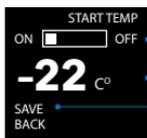
включение/выключение запуска двигателя по температуре
