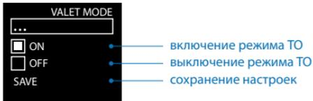
Признаком работы режима техобслуживания является свечение индикатора состояния зеленым светом при включенном зажигании. Выход из режима ТО доступен и при выключенном зажигании.
