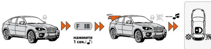
Если система находится под охраной, то одновременно с открытием замка багажника из контура охраны исключается зона багажника и отключается шок-сенсор и доп. датчик, все остальные зоны остаются под охраной.
