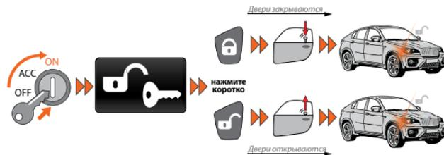
(программируемая функция). Если после включения зажигания какая-либо дверь открывалась, автоматического запирания не произойдет – это необходимо для предотвращения запирания ключей зажигания внутри автомобиля.
