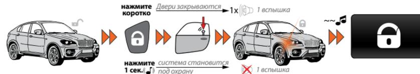
При постановке на охрану система осуществляет контроль всех тревожных зон, обеспечивает запирание замков дверей и блокировку двигателя.
