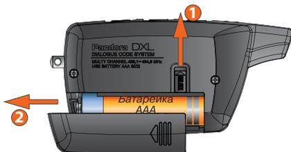
При использовании качественных элементов питания брелок охранно-сервисной системы может функционировать без замены элемента питания до 6 месяцев.
