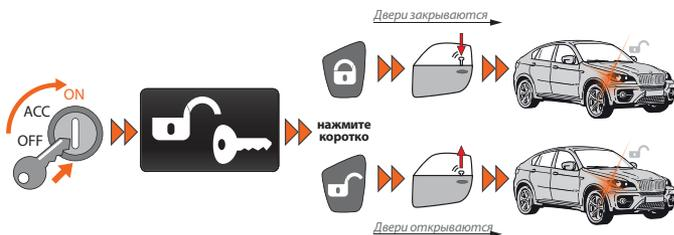
Запирание и отпирание дверей можно производить принудительно с брелока без постановки на охрану при включенном зажигании. Для этого при включенном зажигании коротко нажмите кнопку - двери при этом закроются, а нажатие кнопки откроет замки дверей.
