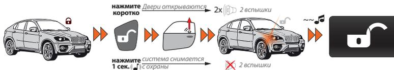
Для снятия системы с охраны коротко нажмите на кнопку брелока, при этом Вы услышите два коротких звуковых сигнала и увидите две вспышки указателей поворотов, брелок проиграет мелодию «снятие с охраны», пиктограмма состояния системы охраны примет вид: .
