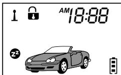
**Выключение** режима производится одновременным коротким нажатием этих кнопок и подтверждается 3-мя вспышками указателей поворотов и «ЧИРПами» sireны, мелодией брелока.
