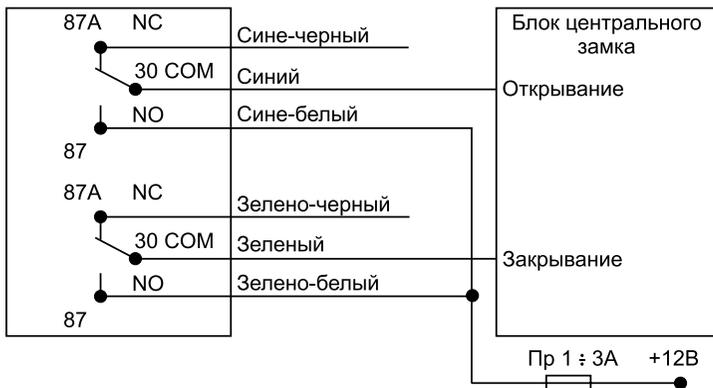
Управление Ц.З. отрицательными импульсами (время упр. 0.8 сек)
