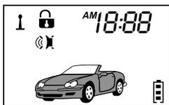
В этом случае система будет полностью работоспособной, за исключением звукового оповещения сиреной. Вся текущая информация будет отображаться на дисплее LCD брелока. **Включение** сирены производится однократным нажатием этой же кнопки в режиме охраны, подтверждаемое «ЧИРПом» сирены, вспышкой указателей поворотов и сигналом брелока.
