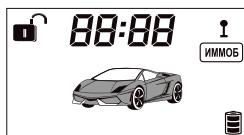
Для отключения иммобилайзера нажмите кн.
