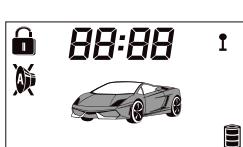
В этом случае система будет полностью работоспособной, за исключением звукового оповещения сиреной. Вся текущая информация будет отображаться на дисплее LCD брелока. Включение сирены производится однократным нажатием кнопки
