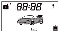
В заводских установках (функция 8-1, стр. 38) 1 доп. канал используется для открывания багажника с фиксированным временем активации (0.8сек).
