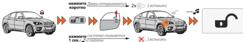
Для снятия системы с охраны коротко нажмите на кнопку брелока, при этом Вы услышите два коротких звуковых сигнала и увидите две вспышки указателей поворотов, брелок проигрывает мелодию «снятие с охраны», пиктограмма состояния системы охраны примет вид: .
