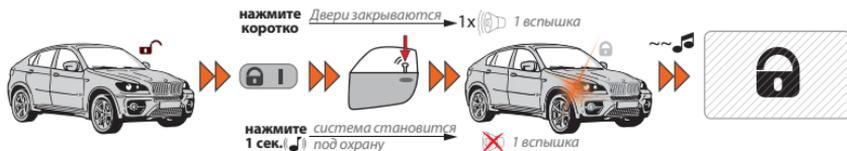
При постановке на охрану система осуществляет контроль всех тревожных зон, обеспечивает запираение замков дверей и блокировку двигателя.
